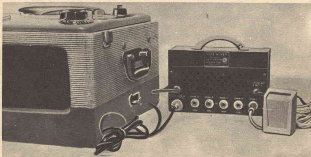
Il registratore 1 e il microfono collegato attraverso il miscelatore a 4 canali.
